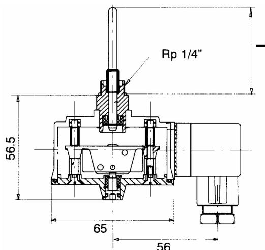
Рис. 11. Чертеж переключателя с индикацией положения "Закрыто"
