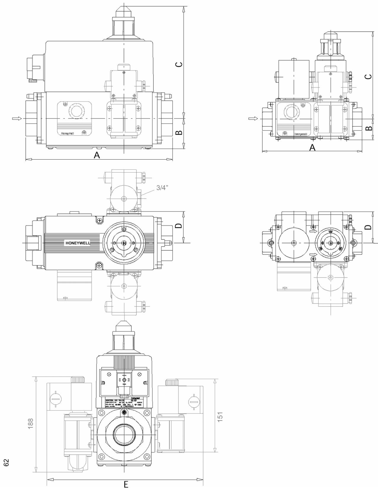
Таблица 2 Размеры для клапанов серии vq400 (смотрите также установочный чертеж)
