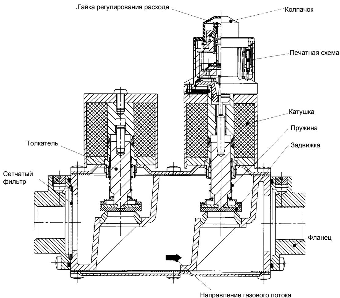
Рис. 11. Устройство клапана VQ 420/425
